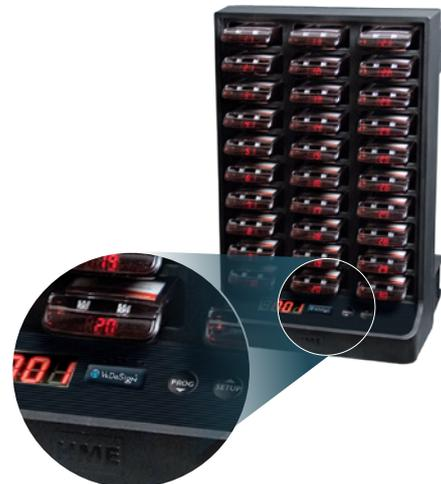
**Autonumérotation:** Appuyer la touche "PROG" pendant 10 sec. jusqu'au signal sonore. Lacher-prise et ensuite de nouveau appuyer pendant 2 sec. jusqu'au signal sonore
