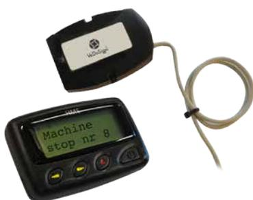
Aktivität vorliegt. VeDoSign bietet verschiedene Trockenkontakt-Transmitter an, die Sie an einen Ausgang anschließen oder die Teile bewegen können. Sobald eine Aktivität stattfindet, wird eine Textnachricht an einen Pager gesendet. Wir bieten Geräte mit einem Ausgang und Geräte mit mehreren Ausgängen an.
